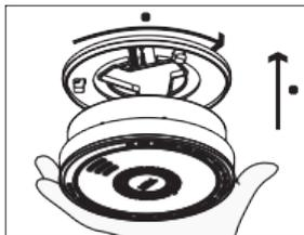
6. Instale la alarma de nuevo en la placa de montaje y gire en sentido horario hasta que quede fijo.
